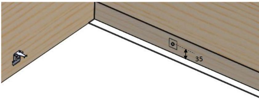
le montage des coulisses se réalise sur la face avant et arriere de l'equilux. La fixation doit se trouver a 35 mm du bas de la tremie puis dans les percages deja prevu sur les coulisses. Attention a laisser le trou libre afin de passer le cordon d'alimentation du store
